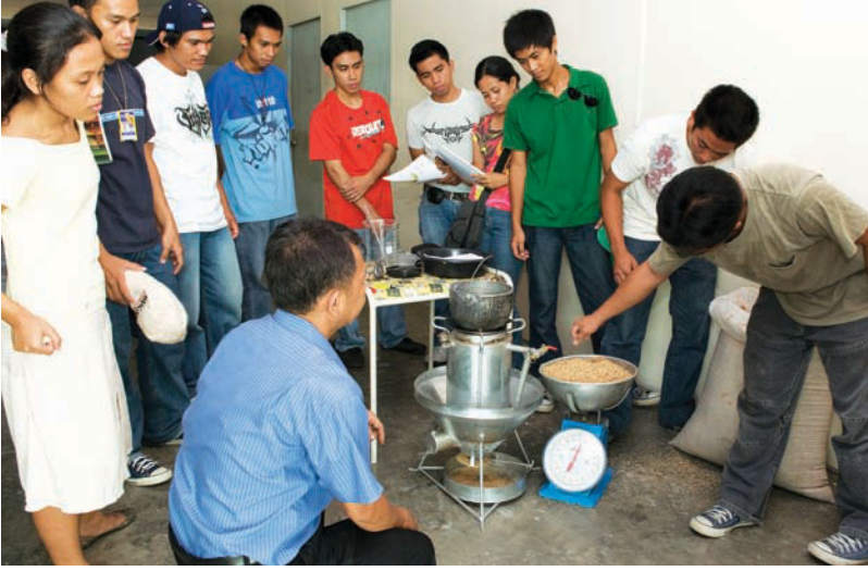
بيلونيو يعلّم طلاباً في كلية الهندسة الزراعية في جامعة وسط الفلبين كيف يعمل موقد التغويز الذي يستهلك نحو كيلوغرامين من قشور الرز كل ساعة لإنتاج غاز حيوي للطبخ
