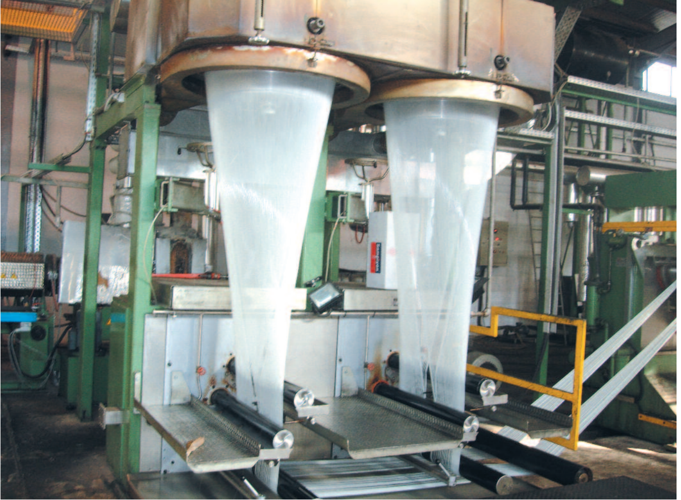
آلة لتحويل نفايات البلاستيك الى ألياف بوليستر في مصنع ليفيكو
