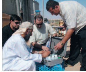
أخذ عينات لفحص جودة المياه الجوفية
