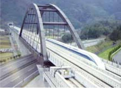
بدأ «قطار ماجليف الطائر» الياباني طلعته التجريبية. وهو يعتبر أحد أسرع ثلاث وسائل نقل في العالم، ويتم التحكم فيه بواسطة الكمبيوتر من دون حاجة إلى سائق. وهو يعمل من دون محركات أو عجلات أو وقود أو كهرباء، حيث يعتمد على الطاقة المغناطيسية التي ترفعه عن مساره وتمنحه سرعة فائقة تجعله يقطع 500 كيلومتر في الساعة. وسوف يكون جاهزاً للخدمة التجارية بحلول سنة 2027، ليربط بين العاصمة طوكيو ومدينة ناغويا.
