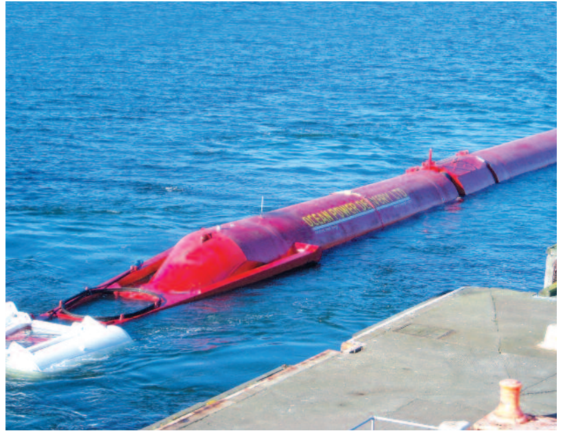
وحدة لتحويل طاقة الأمواج إلى كهرباء في بريطانيا. وقد افتتحت مؤخراً أكبر مزرعة أمواج تجارية في العالم قبالة شاطئ البرتغال، تفاصيلها في الصفحة 63 من هذا العدد
