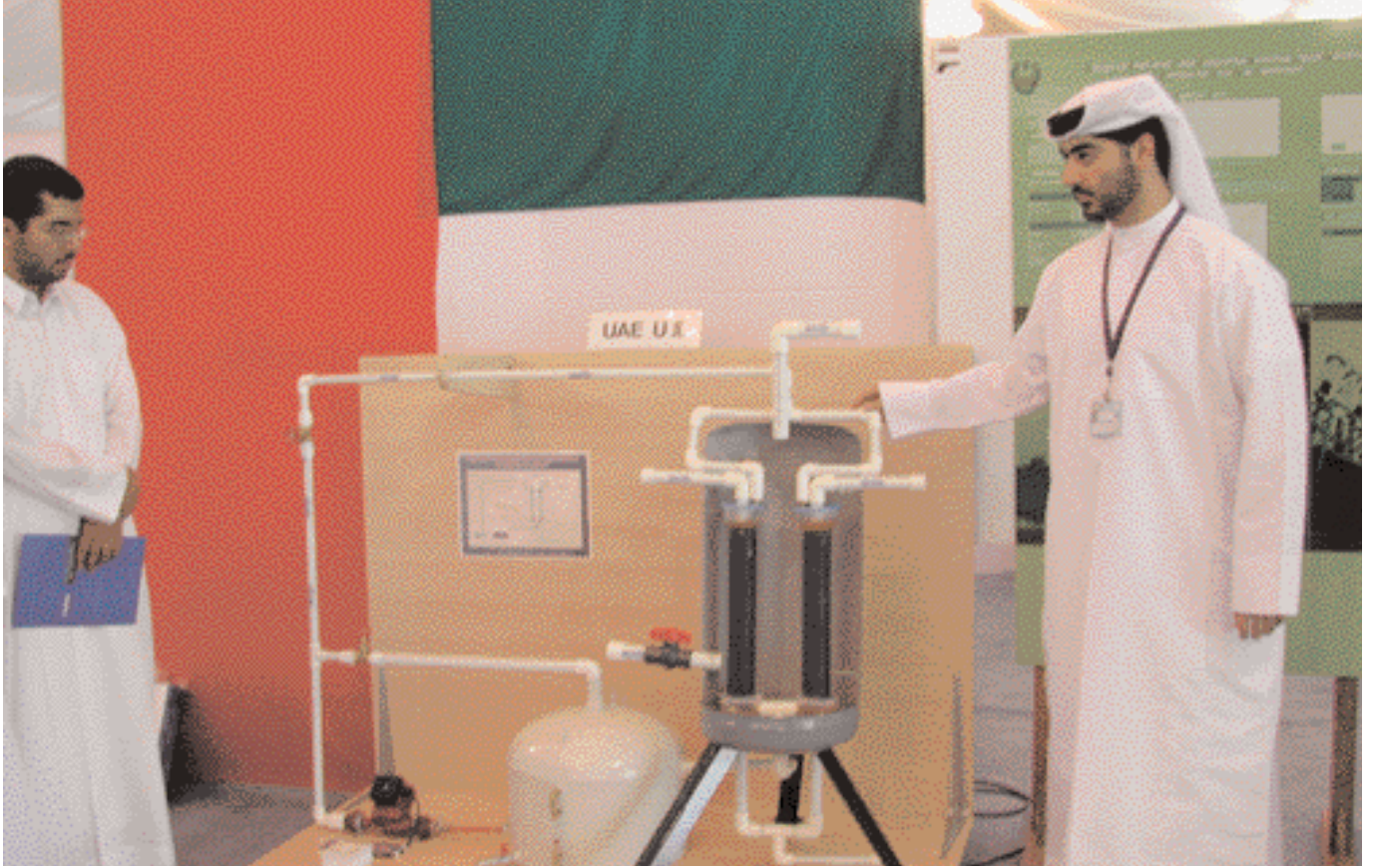
جهاز لمعالجة الغازات الحامضة التي تنتفها العمليات الصناعية، صممه فريق من طلاب الهندسة في جامعة الامارات
