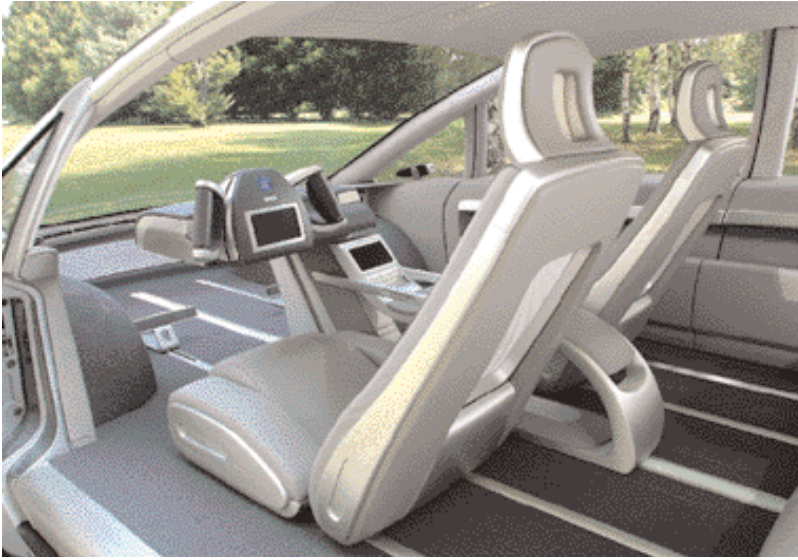
سيارة هاي - واير الكهربائية - الهيدروجينية من جنرال موتورز: تشغيلها يدوي بلا دواسات للقدم الى اليمين: تصميم فني للسيارة فوق: داخل السيارة التي عرضت في دبي
