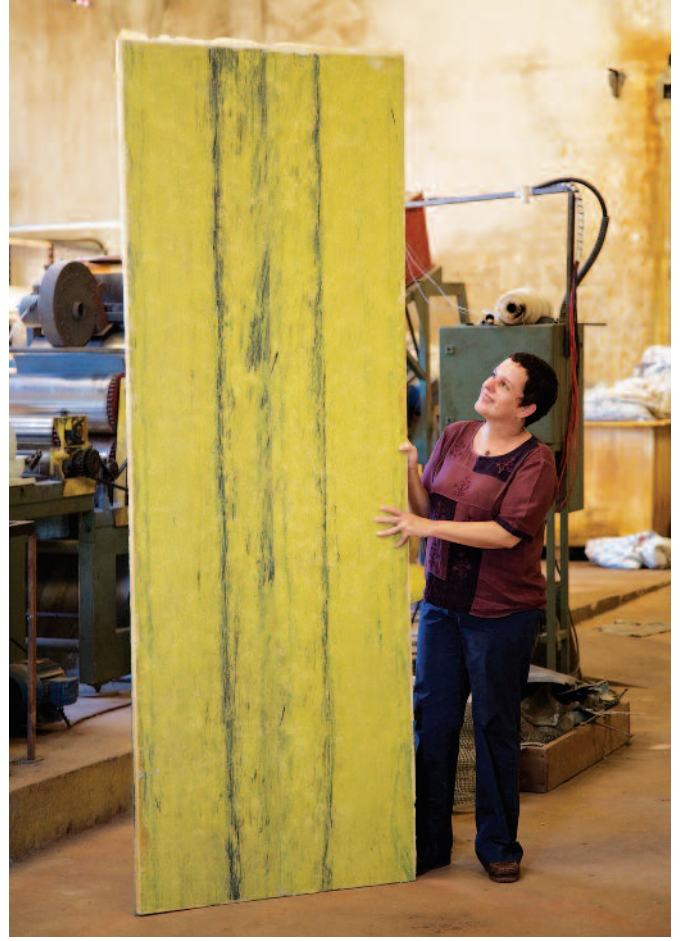
طورت إلسا زالديفار إنتاج ألواح مصنوعة من بلاستيك معاد تدويره ونفايات نباتية لاستعمالها في بناء المنازل والسقوف والأثاث
