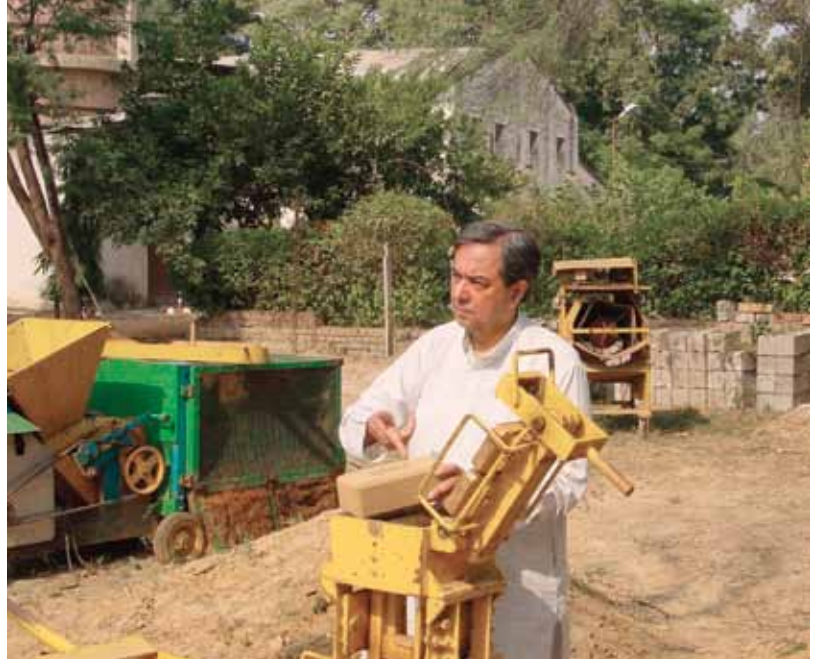
خوسلا يجرب مكبس TARA Balram الذي ابتكرته منظمة بدائل التنمية، لكبس التراب وتحويله إلى طوب تبني به منازل بكلفة زهيدة
