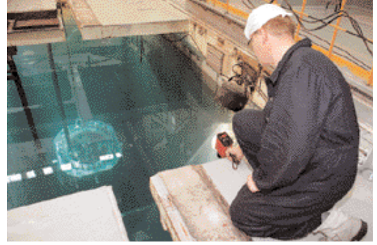
تقني روسي يقيس مستوى الاشعاع في حوض للنفايات النووية قرب مدينة كراسنويارسك في سيبيريا
