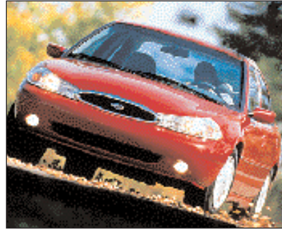
سيارة «كونتور» من شركة فورد تعمل بوقودين: الغاز الطبيعي أو البنزين
