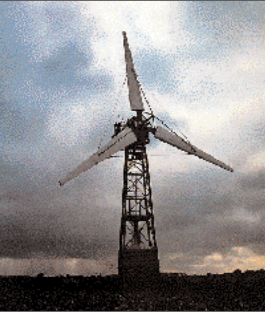
«مولد هوائي» للكهرباء قطره 20 متراً ينتج 100 كيلوواط في رياح سرعتها 45 كيلومتراً في الساعة
