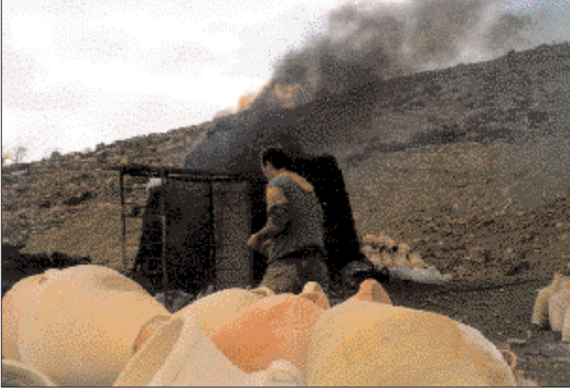
مصنع فخار. كثيراً ما تستخدم زيوت السيارات المستعملة والاطارات القديمة وقوداً في المصانع الصغيرة والأفران مما يلوث الهواء
